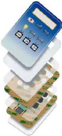
3M™ Membrane Switch Spacer
